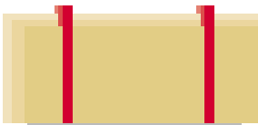
Za aklimatizaciju na gradilištu: Ploče složene s letvama
