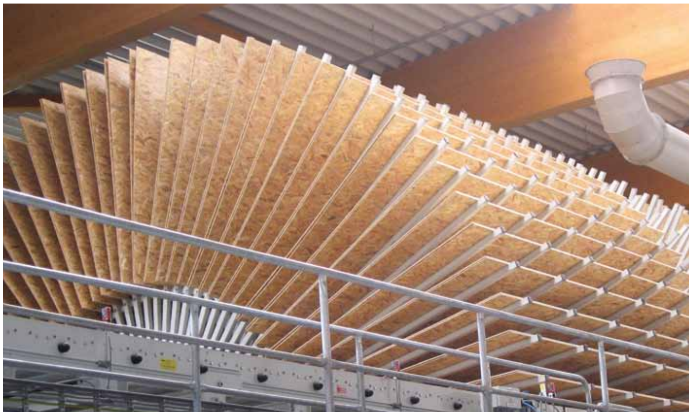
Wysokie standardy jakości: Plyty OSB w obrotowym urządzeniu chłodzącym w zakładzie EGGER.
