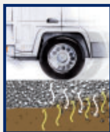
Gubitak materijala nosivog sloja bez TS-a
